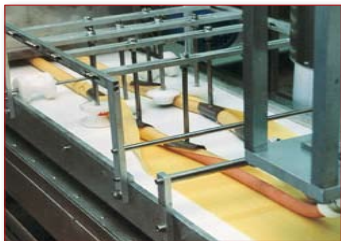
Sistema brevettato per l'avvolgimento del cannellone
